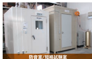
防音室/短絡試験室
