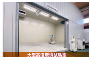
大型高温環境試験室
