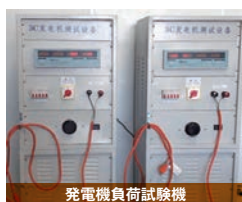
発電機負荷試験機
